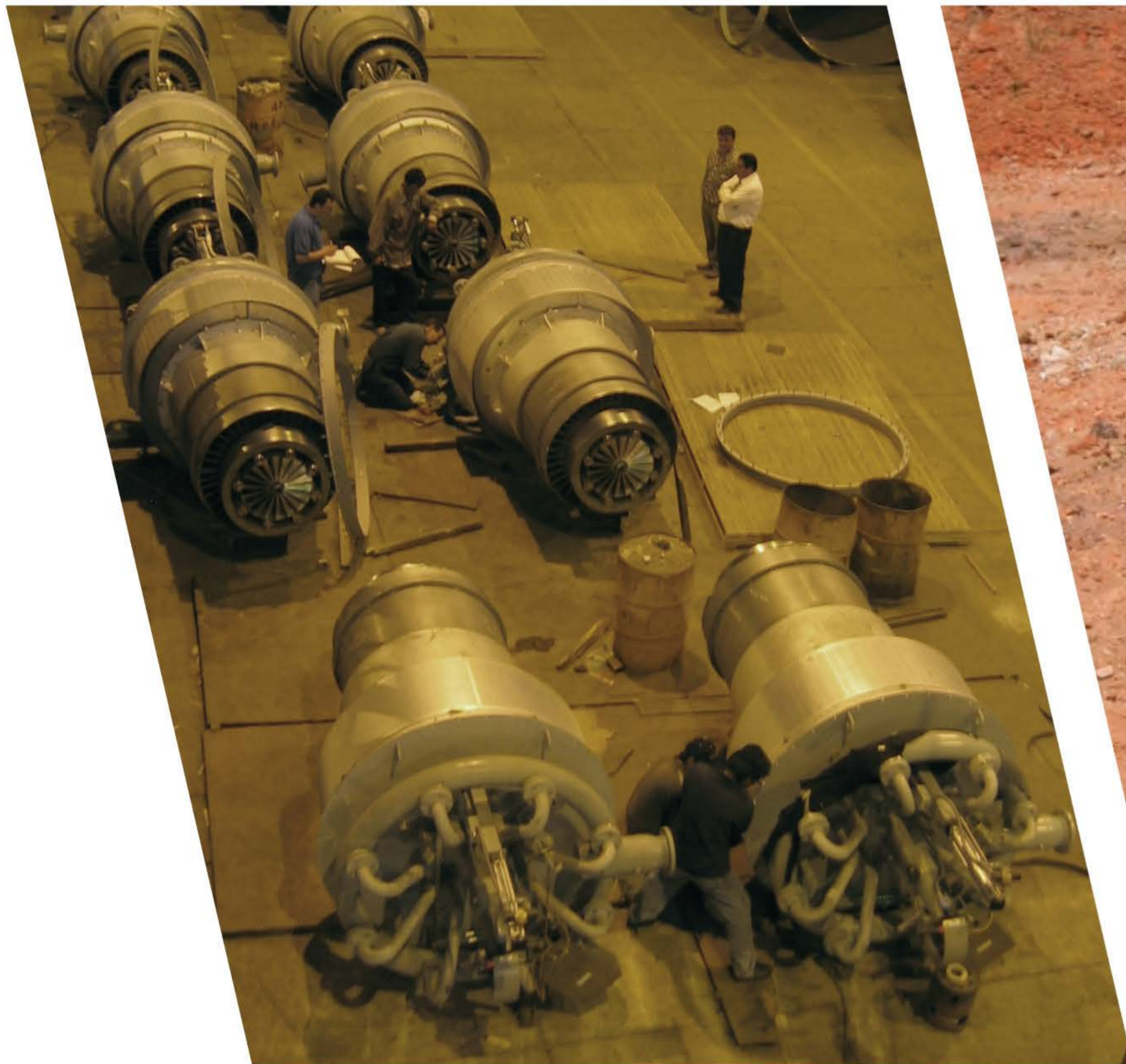
Quemadores de calderas
