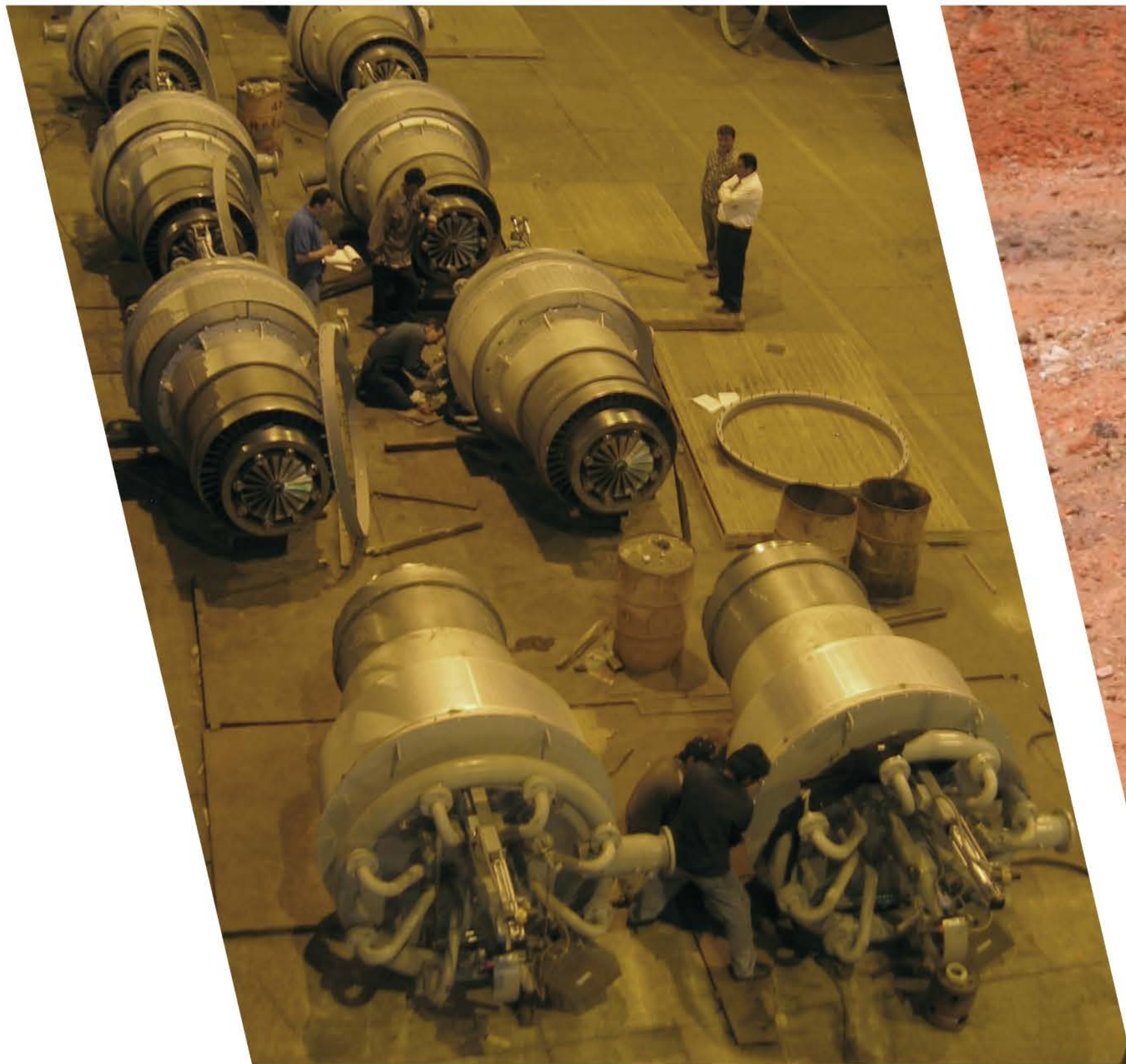
Quemadores de calderas
